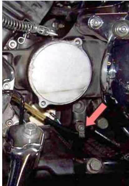
Zdjęcie 5. Położenie śruby mocującej przewody
