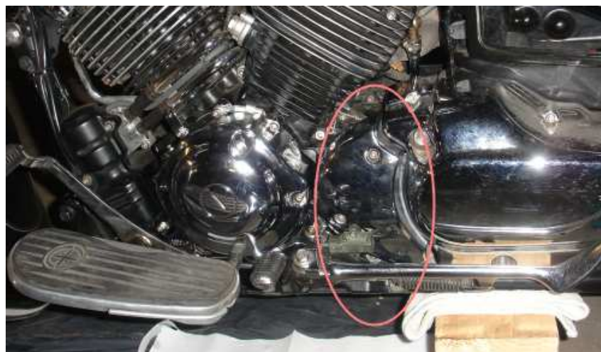
Zdjęcie 4. Położenie tylnej pokrywy do demontażu
