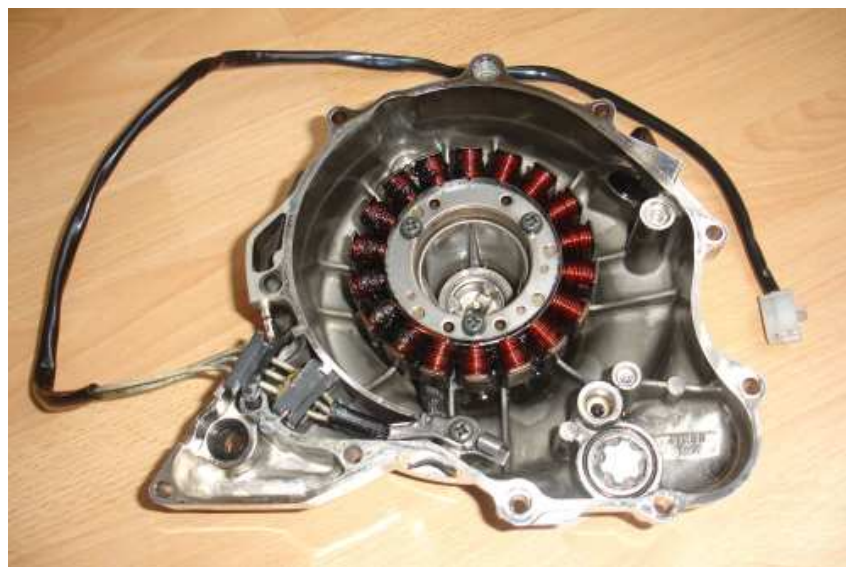
Zdjęcie 9. Pokrywa po demontażu impulsatora
