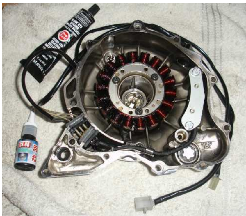
Zdjęcie 12. Wnętrze pokrywy po montażu i uszczelnieniu
